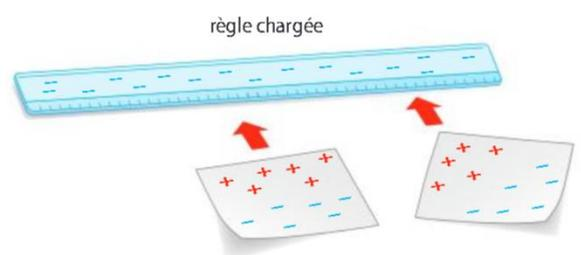
Lorsque la règle est frottée c'est une électrisation par frottement.
